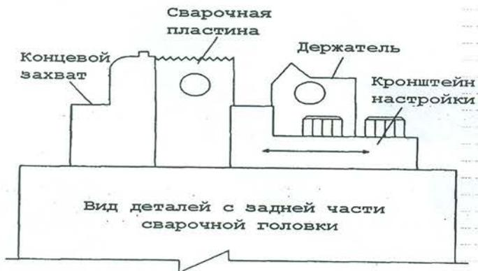
Схема 22. Просвет между сварочной пластиной и концевым захватом
